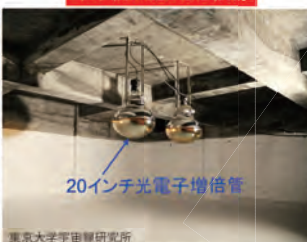
地下水チェレンコフ型ミュオン粒子 観測装置(注水前) ひとつ当たり約50 m 2
