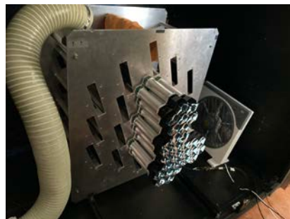
図 2.PMT モジュールのテストベンチ。冷却空気を送風している。
