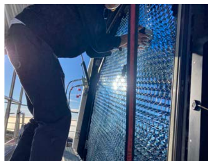
図 3. カメラ前面を開けてモジュールを交換している様子。普段カメラ前面は紫外線透過アクリル窓により密封されている。観測終了毎にカメラはこの交換等の作業ができるように設計された台に収納されている。
