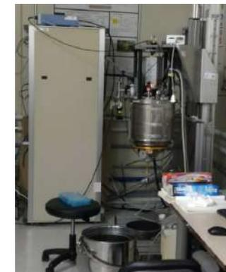
核断熱消磁や希釈冷凍機により40mKまで冷やすと粒子識別能力発光量も増える。異方性も増す?
