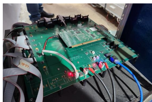
図1. 明野ミュオン観測用の新型 DAQ 回路
