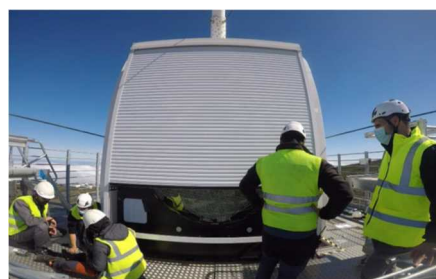
図 1. 大口径望遠鏡 1 号機に搭載されているカメラ。2.3m 口径、1855 本の PMT を搭載。シャッターの奥に窓ガラスがあり、検出器とフロントエンド電子回路は外気から遮断されている。熱は冷却水により望遠鏡土台に設置している冷却器まで運ばれる。
