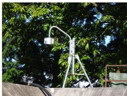
図1. M5屋上に設置した電場計
