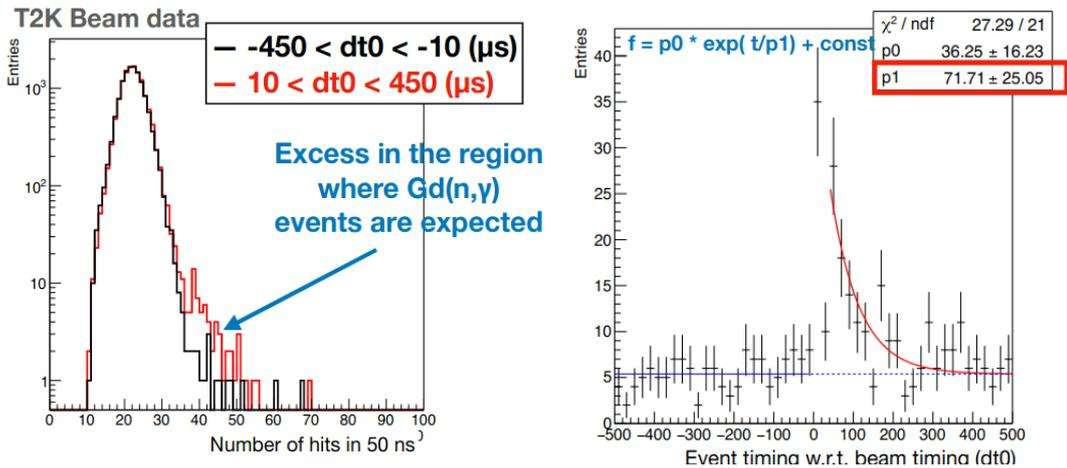
Run11における中性子検出を示す図。左図は、ビームタイミング前（黒）後（赤）のイベントのヒット数分布でビームタイミング後10マイクロ秒から450マイクロ秒で超過が見える。右図はビームタイミング前後の事象のタイミング分布であり、ガドリニウムによる中性子捕獲の様子が見えている。
