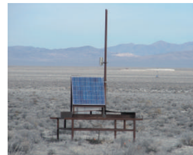
米国ユタ州の砂漠に設置されたテレスコープアレイの地表検出器
