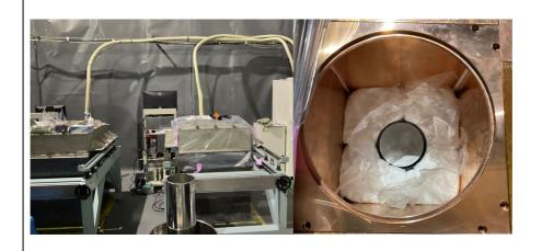
(左図): 従来から活用していた極低放射能 HPGe 検出器(左)と 2022 年度新たに導入した極低放射能 HPGe 検出器(右) 従来のものと同じ厚さの遮蔽体構造、測定試料を置くスペースのサイズを有し、測定感度も同程度であることから、神岡での硫酸ガドリニウムのスクリーニングを 2 倍の速さで行うことが可能になった。(右図): 実際に硫酸ガドリニウム八水和物 10 kg を 2022 年度導入した HPGe 検出器で測定している写真。
