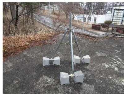
図 2. M5 屋上に設置した電場計土台
