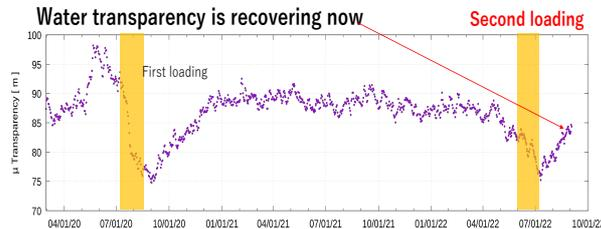
図 2: 水の透過率 (タンクを突き抜けるミュオンの光量を用いた光の減衰長) の時間変動。'Second loading'が、2022 年夏に行った追加導入時期を示す。導入時には一時的に低下するが、その後、回復していることが見て取れる。
