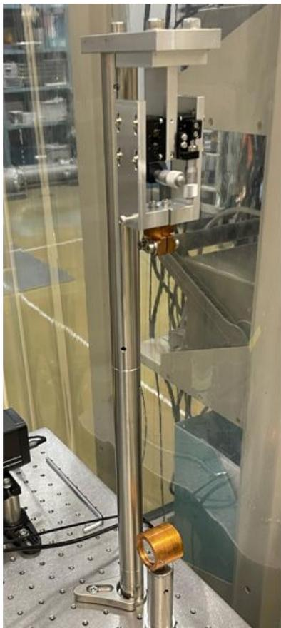
干渉計の片方を吊るし振り子にする
