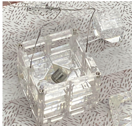
Am/Be線源とBGOシンチレータ
