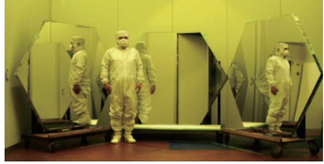
図5 日本グループ、三光精衡所により試作された大口径望遠鏡用の高精度分割鏡。ミラーは60mm厚のアルミニウムを3mmのガラスではさんだサンドイッチ構造である。鏡表面はSiO 2 , HfO 2 の多層保護膜により長寿命、高反射率を実現する。
