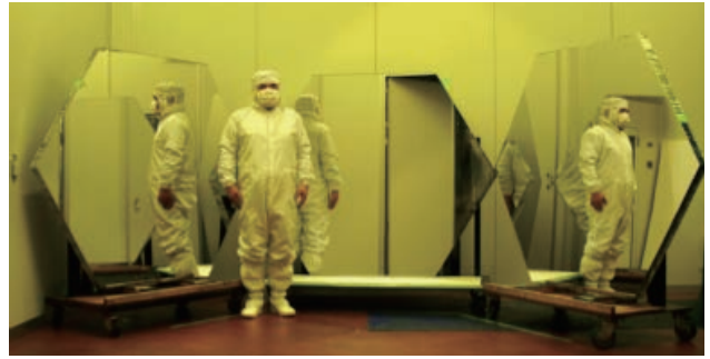
図5 日本グループ、三光精衡所により試作された大口径望遠鏡用の高精度分割鏡。ミラーは 60mm 厚のアルミニウムを 3mm のガラスではさんだサンドイッチ構造である。鏡表面は SiO 2 , HfO 2 の多層保護膜により長寿命、高反射率を実現する。 Prototype of the high precision segmented mirror for the LST developed by CTA-Japan in cooperation with Sanko Co.LTD. The mirror is made of a 60mm thick aluminum honeycomb sandwiched by 3mm thin glass on both sides. A surface protection coat consisting of the materials SiO 2 and HfO 2 will be applied to enhance the reflectivity and to elongate the lifetime.
