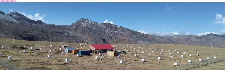
ボリビアにあるALPACA検出器の写真。既にデータ取得を開始しており、シンチレーション検出器を格子状に並べて、宇宙線と大気との反応で生じる空気シャワーを観測しています。
