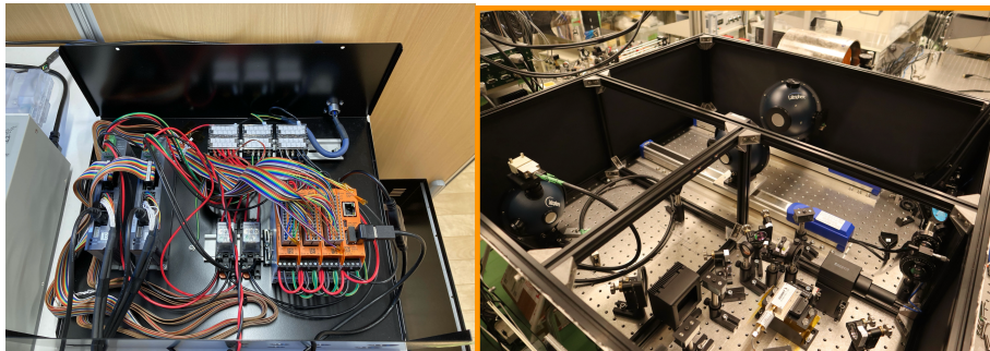
図 3: 構築した control and measurement system(左)と光学系(右)。制御、測定システムは安定性および KAGRA での経験から産業用ラズベリーパイ RevPi を採用。
