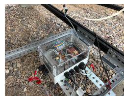
図 3. CRAFT 望遠鏡の下に取り付けられた環境モニター。風速計や雨滴形は望遠鏡の上部に設置(図 2 参照)。
