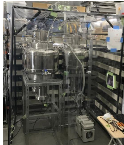
図1 移設後の Gd 水用ラドン検出器
