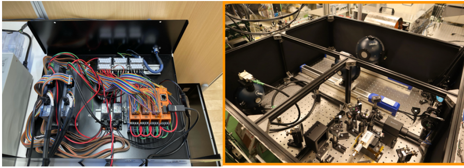
図2: 構築した control and measurement system(左)と光学系(右)。制御、測定システムは安定性および KAGRA での経験から産業用ラズベリーパイ RevPi を採用。
