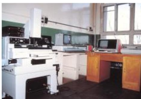
図.10 高能研に設置した自動光電濃度測定装置
