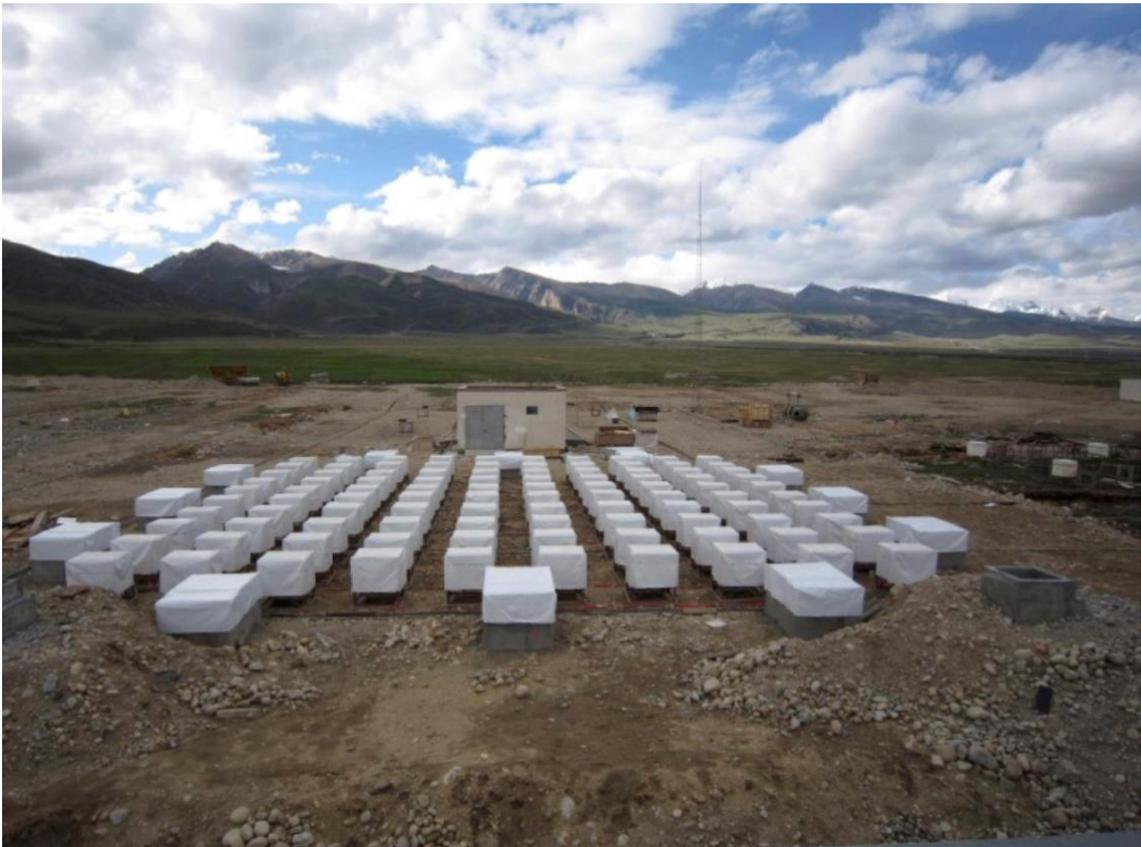
図.14. YAC(空気シャワーコア観測装置)全景. (地下ミュオン観測装置建設のために、周辺の空気シャワー観測装置の一部が撤去されている。)
