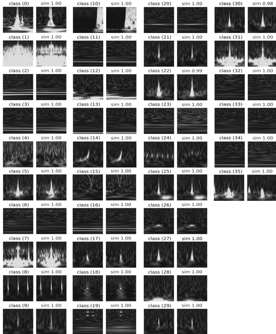
図 1: 改良したアルゴリズムによりグリッチを分類した結果. 分類された全クラスにけるグリッチの代表画像 (時間-周波数画像) とその類似画像. 例えば, Class(1)と書かれた画像は分類されたクラス 1 のグリッチの時間-周波数画像からランダムに選んだ代表画像. その右側の画像は代表画像に対応するクラス内でのグリッチ画像. 同様の特徴を持つグリッチが同じクラスに分類されていることが確認できる.
