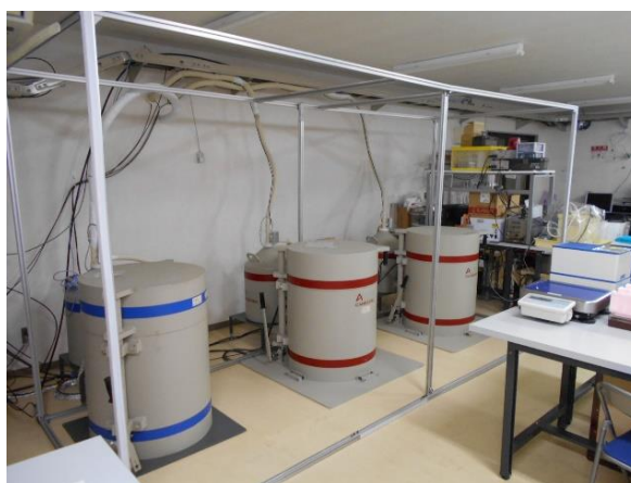
図：左の検出器を移設し、1か所にまとめた状況。3台の高純度 Ge検出器がまとめて運用できる状態にした。
