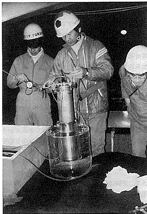
写真1 CF装置の外観。ステンレスパイプの内部にCFサンプルを挿入する。外部の透明な容器は20%濃度の塩化ナトリウム溶液。ここで中性子は減速された後に塩素に吸収されγ線を放出する。γ線はさらに水中でチェレンコフ光を発生し、装置の内面に多数取り付けられている光電子増倍管によって測定された。
