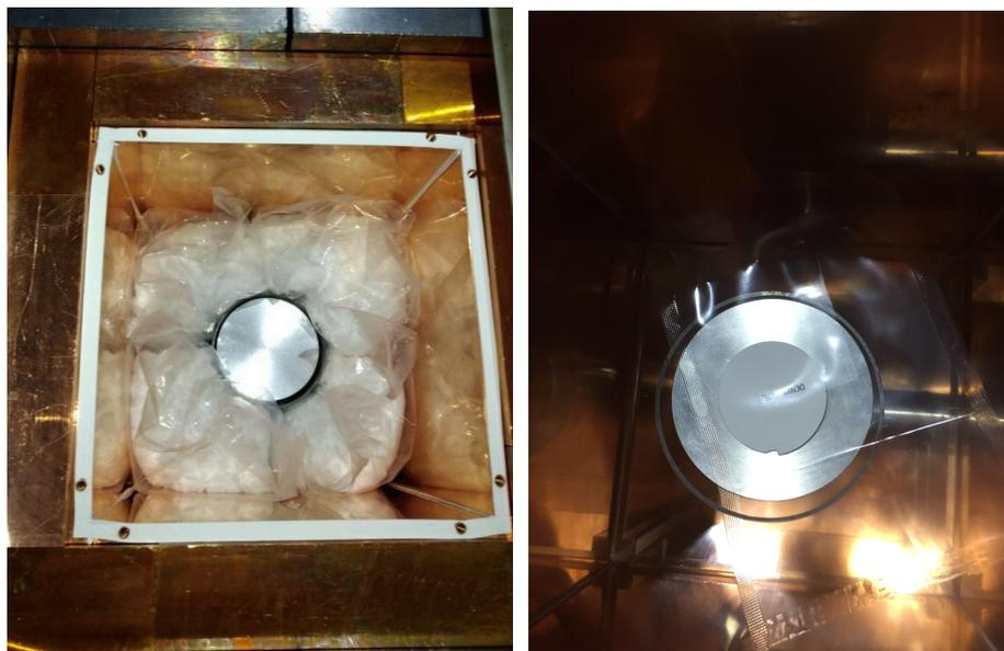
図 1(左) : 硫酸ガドリニウム八水和物 10 kg を HPGe 検出器で測定している写真。2019 年度までは試料を詰めた袋に含まれる空気のためかさばり、5 kg の測定が限界であった。本年度純空気によるパージと空気抜きシステムを構築した結果、10 kg の測定が可能になった。(右) 硫酸ガドリニウム八水和物に含まれるラジウムを吸着した固相ディスクの測定時の写真。試料体積を低減することにより、放射性不純物由来のガンマ線検出効率が約 1 桁向上出来た。
