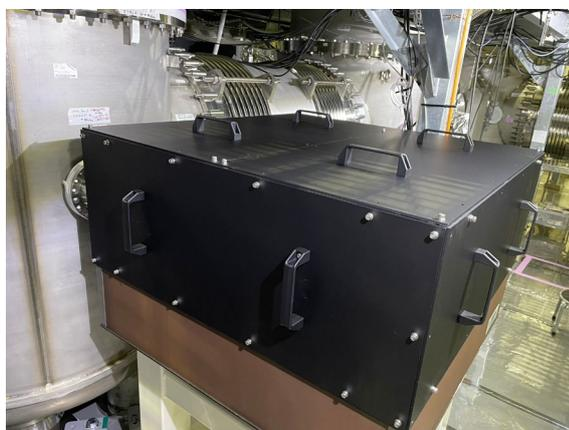
図 1 IMM チャンバー横に設置された ISS。システムは光学定盤上に組まれ、黒色アルミ板の風防・防音壁で覆われている。チャンバー側面に部分的に見えている光学窓を通して IMMT 透過光が導かれる。
