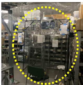
図 1. Super-Kamiokande タンク上 (エレクトロニクスハット 1 裏) に新たに構築したクリーンブース内に置かれた高感度ラドン検出器 (黄色破線内)。Super-Kamiokande 水タンクの送水・返水ラインの水を連続的に検出器に流し、水中のラドン濃度をモニターすることが可能。
