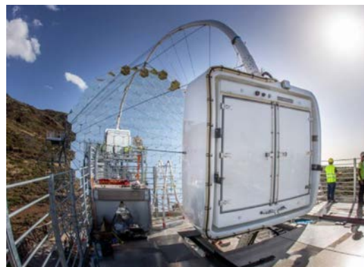
図 1. LST1 号機に搭載したカメラ。高さ 3m のカメラ筐体に口径 2.3m の焦点面検出器が搭載されている。
