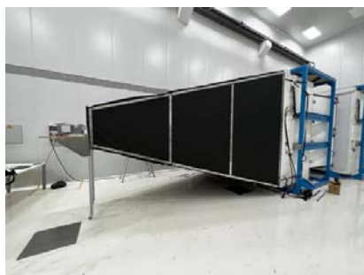
図3、LST4号機用のカメラにテスト用の暗箱を装着しているところ。この状態でカメラを稼働させ、一様な光を照射することにより全ての検出器をテストする。
