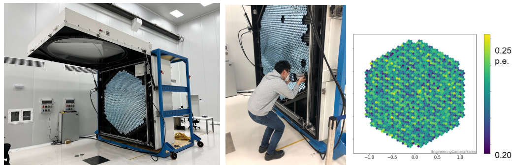
図 2 : CTA 北サイトがある ORM 天文台を所管するスペイン IAC 研究所の実験室において、統合試験中の LST 2 号機カメラ(左)、動作不良モジュール交換作業(中央)、ノイズ分布(右)。
