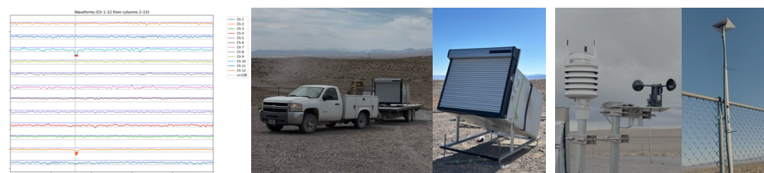
図：自動観測試験においてエニーツーライントリガーで取得した波形の例(左)、移設の様子と LR に設置後の固定された望遠鏡(中)、環境モニターの風速計、雨滴計とウェザートランスミッター、および Starlink のアンテナ(右)
