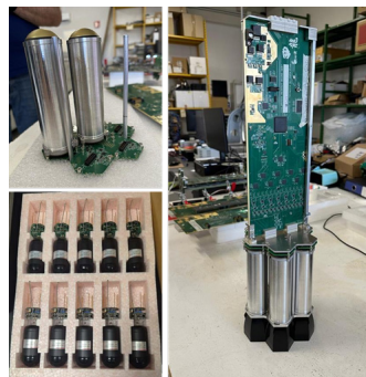
図4：量産中の南半球サイトLST 5-6号基用PMTモジュール。
