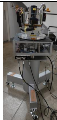
図 1:加速度計内蔵の鉛直線偏差計測用治具 (左) と計測時のセットアップ (右)
