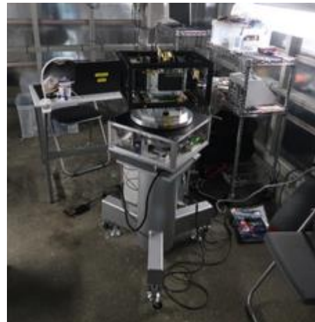
図 2:明野観測所に設置しているスライドルーフ内での鉛直線偏差計
