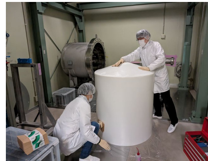
図 2 : HDPE 筒を 1000L 検出器にインストールする様子
