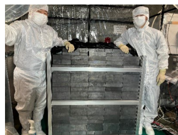
図 2 簡易クリーンブース内に設置した鉛遮蔽体
