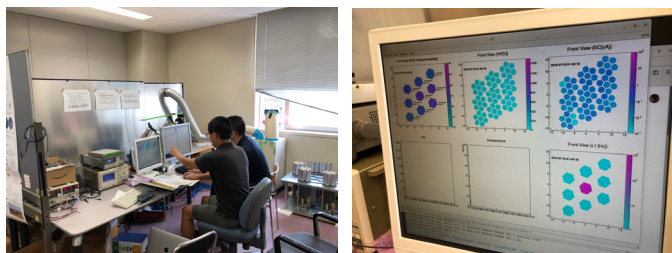
図 4 : (左) LST 2 号機用カメラモジュール試験(ICRR 実験室にて)。 (右) QL 画面。
