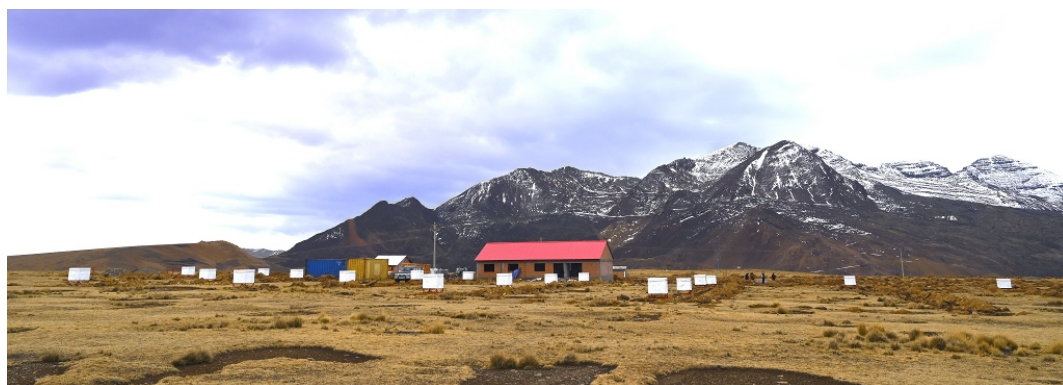
図1 ボリビア・チャカルタヤ山中腹(標高 4740m)に設置された ALPAQUITA 空気シャワーアレイ。白色に見えるのが、シンチレーション検出器。中央の赤い屋根の建物にはデータ収集のための部屋が置かれている。
