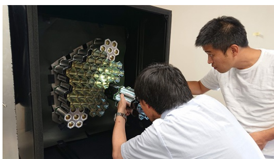
実験室に設置された、PMTモジュールのテスト用暗箱。
