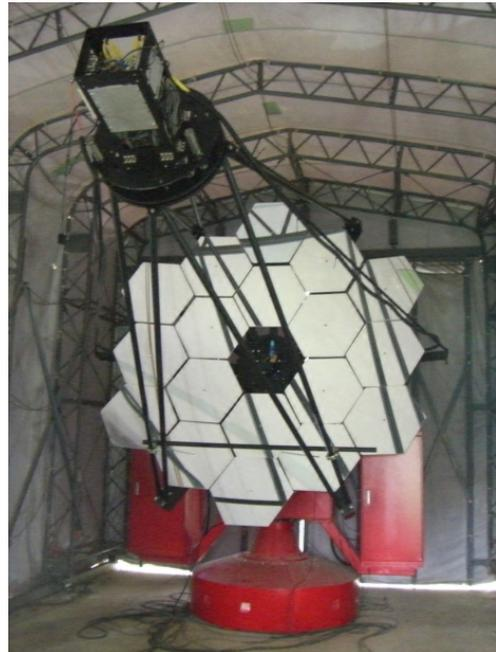
明野望遠鏡で行っている R & D の一つが、32 画素（光電子増倍管）カメラからなる低消費電力データ収集システムの開発である。本システムは明野望遠鏡に導入済みであり、これを用いた試験観測において、既に大気チェレンコフ光像の取得に成功している（参考文献[1]）。別の R & D として、上記システムの一部を流用した「かに」パルサーからの可視光信号の観測を計画し、その準備を進めている。2018 年度より、パルサー観測用システムのオンラインプログラムの開発を武岡（立命館大修士課程学生）が担当し、可視光パルスを高速サンプルするためのスケーラ回路モジュールの読み出し試験を行ってきた。2019 年度には立命館大において、システムの長時間測定試験（長さ一晩程度）、GPS の 1PPS 信号を利用した測定データの絶対時刻較正等を行い、システムが実観測に適したものであることを実証した。システム試験を完了した後、2020 年 1 月に本システムを明野望遠鏡に導入し、「かに」パルサーの試験観測を実
