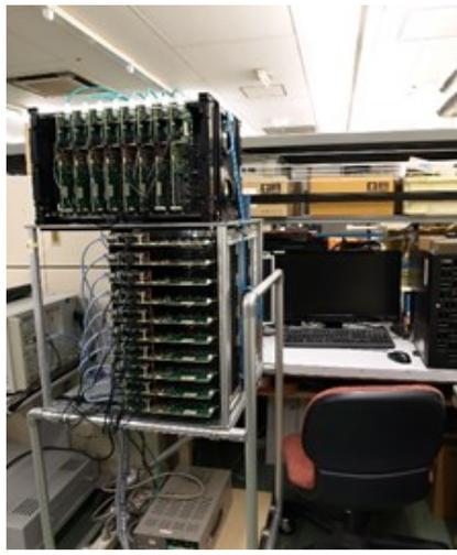
図 3：地上実験室で測定中のソフトエラー率評価装置。
