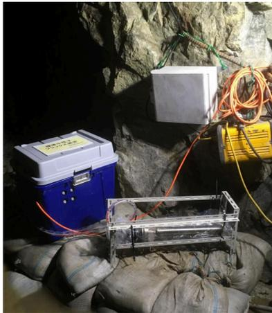
図 1 ハイパーカミオカンデサイトでの  $^3\text{He}$  比例計数管による中性子測定
