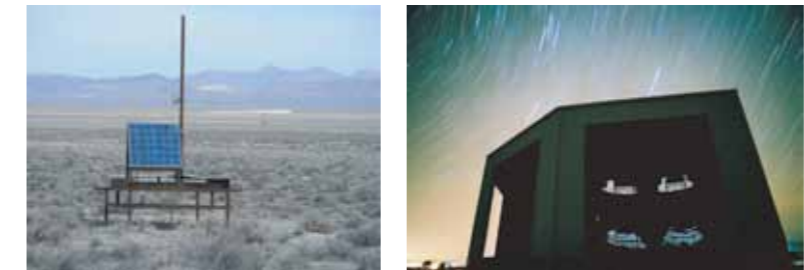
図2 (左図)砂漠に暮盤目状に設置したTAの地表検出器。後方に更に4台が見える。(右図)TA大気蛍光望遠鏡。光電子増倍管によるカメラを用いて空気シャワーからの紫外発光を高速・高感度で撮影する。
