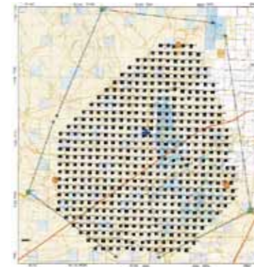
図1 TAの全体配置図。黒い四角は地表検出器の位置を、緑の四角は大気蛍光望遠鏡のステーションを示す。カバーする全地表面積は700km 2 である。
