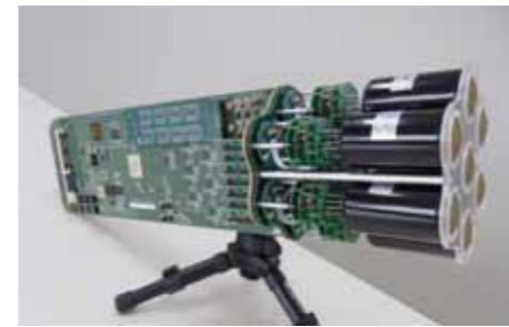
図5 日本グループにより設計、製作された大口径望遠鏡用クラスターモジュール。7本の高量子効率光電子増倍管、高圧回路、プリアンプ、スロー制御回路、超高速DRS4 波形読み出し回路、トリガーからなる、265クラスターモジュールにより大口径望遠鏡のカメラが構成される。
