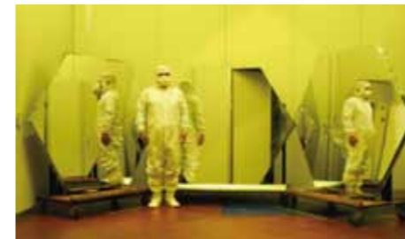
図6 日本グループ、三光精衛所により試作された大口径望遠鏡用の高精度分割鏡。ミラーは60mm厚のアルミニウムを3mmのガラスではさんだサンドイッチ構造である。鏡表面はSiO2, HfO2 の多層保護膜により長寿命、高反射率を実現する。
