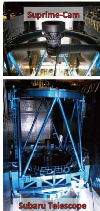
図1 ハワイ島マウナケア山頂に設置された国立天文台の口径8.2mすばる望遠鏡(下)とそのトップリング上に装着されたSuprime-Cam(上)。
