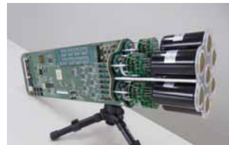
図5 日本グループにより設計、製作された大口径望遠鏡用カメラモジュール。7本の高量子効率光電子増倍管、高圧回路、プリアンプ、スロー制御回路、超高速DRS4 波形読み出し回路、トリガーからなる。265クラスターモジュールにより大口径望遠鏡のカメラが構成される。
