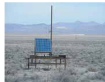
図2 (左図)砂漠に基盤目状に設置したTAの地表検出器。後方に更に4台が見える。(右図)TA大気蛍光望遠鏡。光電子増倍管によるカメラを用いて空気シャワーからの紫外発光を高速・高感度で撮影する。
