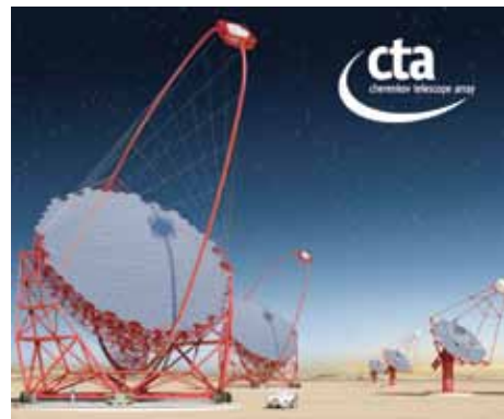
図3 CTA 超高エネルギーガンマ線天文台の想像図。CTA は、大口径(23m)、中口径(12m)、小口径(6m) の三種類の望遠鏡から構成され、20GeV から100TeVにわたる広いエネルギー領域で超高エネルギーガンマ線を観測する。
