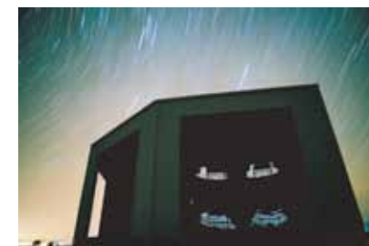
図2 (左図)砂漠に基盤目状に設置したTAの地表検出器。後方に更に4台が見える。(右図)TA大気蛍光望遠鏡。光電子増倍管によるカメラを用いて空気シャワーからの紫外発光を高速・高感度で撮影する。
