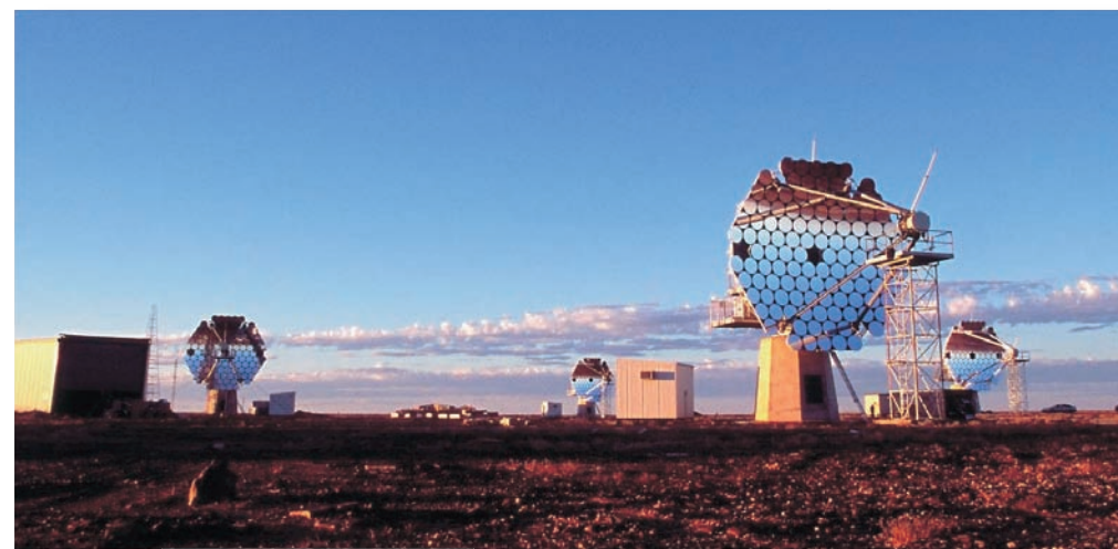
図1 オーストラリア・ウーメラのカンガルー望遠鏡。4台の口径10m望遠鏡からなる。
