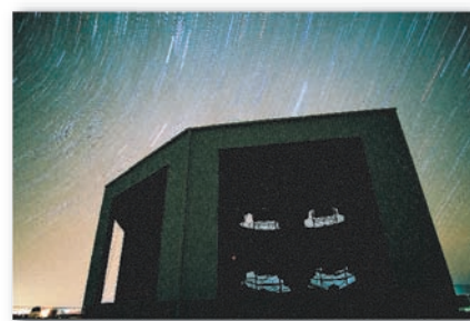
図5 観測運用中のTA大気蛍光望遠鏡。光電子増倍管によるカメラを持ち、空気シャワーからの紫外発光を高速・高感度で撮影する。
