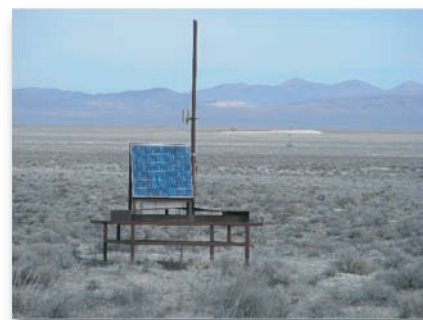
図4 砂漠に1.2km 間隔の碁盤目状に設置されたTAの地表検出器。後方に更に4台が見える。
