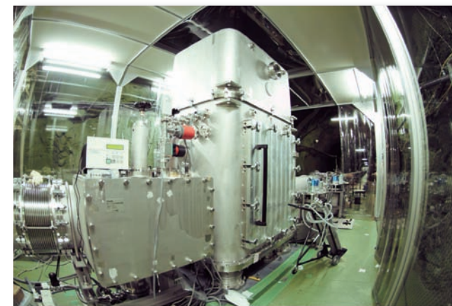
図3 設置された100m基線長の低温レーザー干渉計（CLIO）。光学系と低温部分の調整を行っている。写真は魚眼レンズで撮ったサファイア低温鏡を収めた真空クライオスタット。
