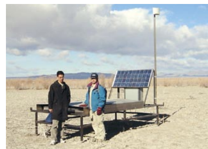
図4 TAの地表粒子検出器。約600台を1.2km間隔の碁盤目状に並べ、700平方kmの地表をカバーする。
