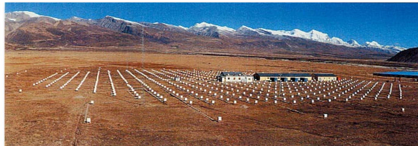
図1 中国チベット自治区の羊八井高原(標高 4,300 m)に設置された空気シャワー 観測装置 Fig.1 Tibet- III air shower array in Yangbajing (4,300m above sea level)
