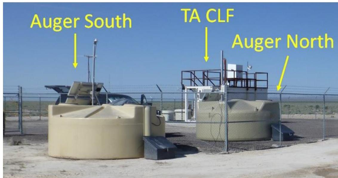
TAの空気シャワー事象と同期したAuger水タンクの信号取得！
