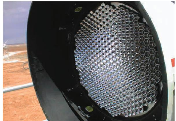
図3 主焦点のイメージングカメラ。光電子増倍管427本の前には集光力を上げるためライトガイドが取り付けられている。
