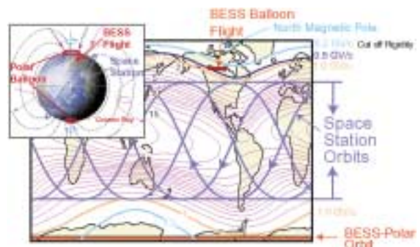
図4：スペースステーション、南極周回気球実験における飛翔プロファイルの比較
