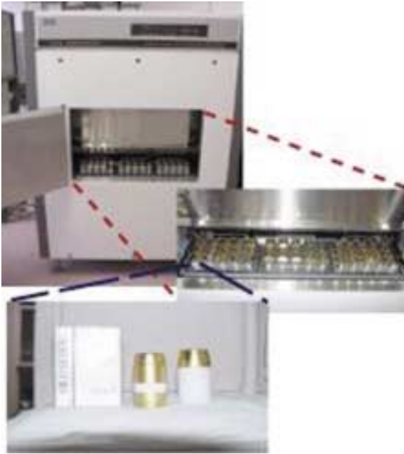
図7：ノングラフィースベンゼン合成装置、極低レベル液体シンチレーションカウンターQuntulus。
