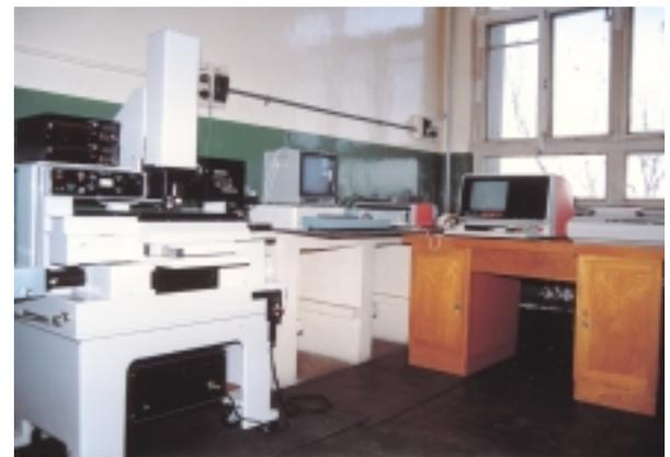
写真6：高能研に送った自動光電濃度測定装置
