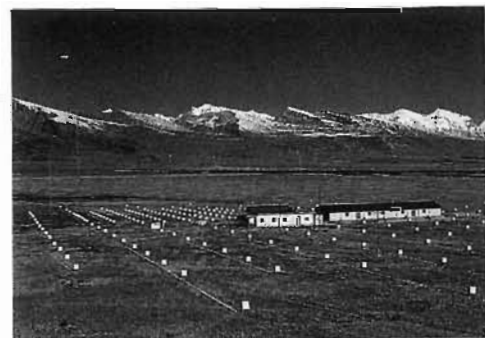
Tibet II 空気シャワー観測装置。奥がTibet HDアレイ。右の建物の中にエマルジョンチェンバーが設置されている。
